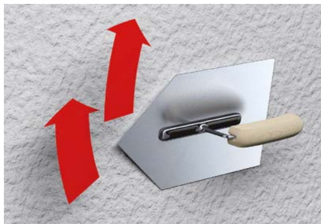
Attēls 4.55. Struktūrapmetuma strukturēšana
