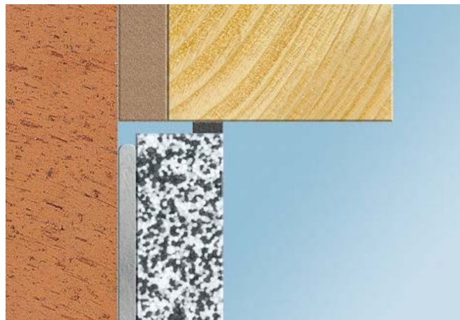
Attēls 6.12. Pieslēgums loga konstrukcijai
