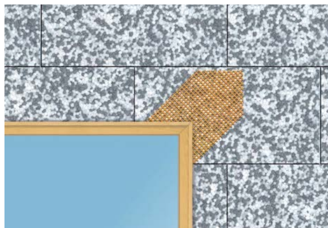
Attēls 4.36. Aiļu stūru diagonālais armējums
