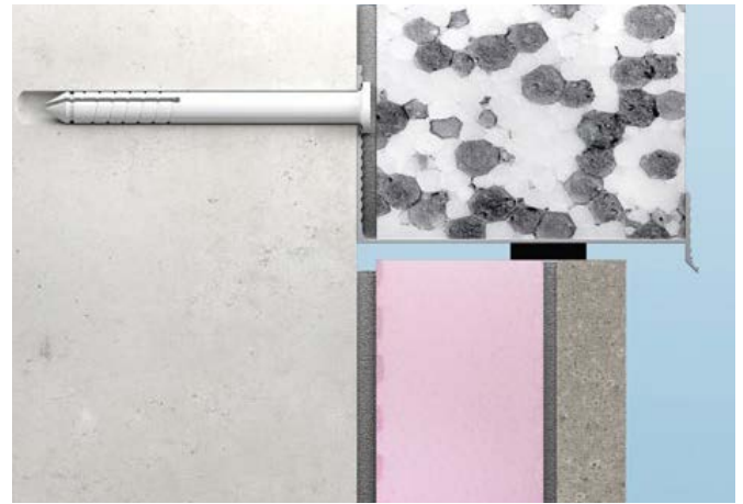
Attēls 5.7. Cokola aizsargplāksnes montāža vienlaidus ar fasādes siltinājumu
