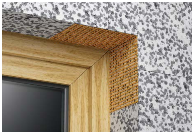
Attēls 4.38. Iekšējo aiļu stūru armēšana
