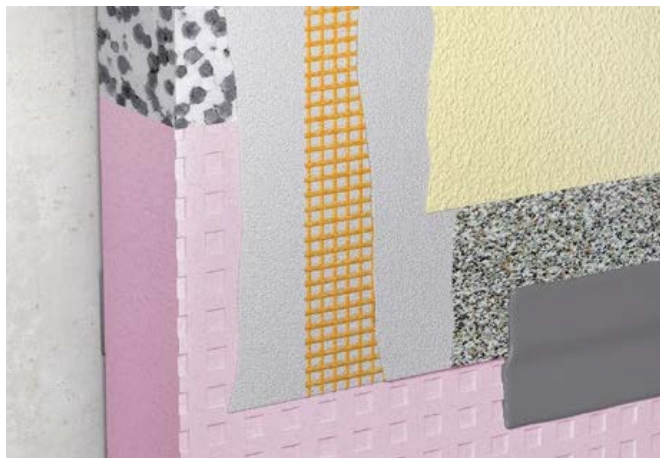
Attēls 9.11. Aizsardzība no kapilārās sūces
