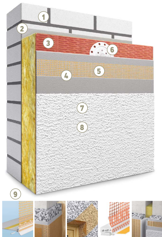
Attēls 2.1. Siltināšanas kompozītsistēmas uzbūve
