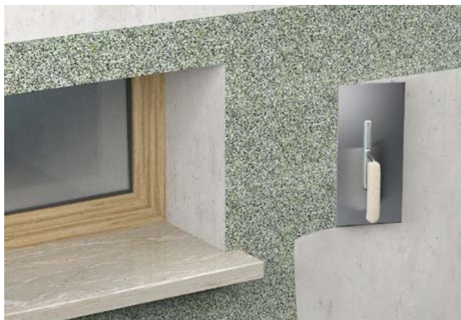
Attēls 4.60. Mozaīkas apmetuma Buntsteinputz uzklāšana
