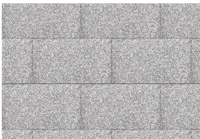
Attēls 4.18. Korekta lokšņu šuvju izveide
